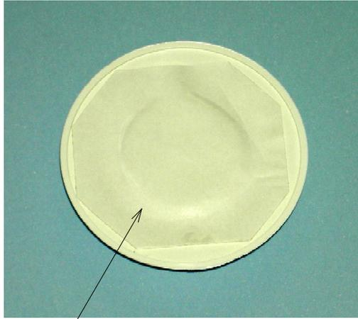
両面テープの白い剥離紙を剥がして感熱板をしっかりと押さえて、天井に貼り付けてください。
